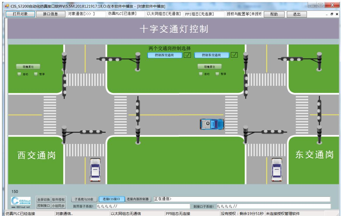
COSAI-S7200 可以在计算机上对 S7-200PLC 的用户程序进行离线仿真与调试。COSAI-S7200 提供了用于监视和修改程序中使用的各种参数的简单的接口，例如使输入变量变为 ON 或 OFF。和实际 PLC 一样，在运行仿真 PLC 时可以使用监控状态表方法来监视和修改变量，并且还可以点击“监控程序”，从而看到由 LAD 程序转换而来的 STL 语言，实现对程序运行过程的实时监控。另外，我们还可将 S7-200 编程中创建的“符号表”复制，然后点击 COSAI-S7200 软件中的“监控状态表”，将符号表粘贴到监控状态表中，使得控制者在程序运行的过程中方便对变量的状态值进行监控。
